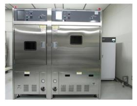
2槽独立型スーパーキセノンウェザーメーターは、照射光が紫外から可視光まで幅広い波長に渡って太陽光に近似しているキセノン光源により、太陽光の約3倍に相当する180 W/m²
